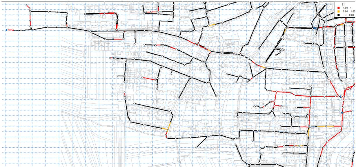
Rohrfüllungsrad bei Weiterleitungsmenge von Röschenz von 700 l/s
