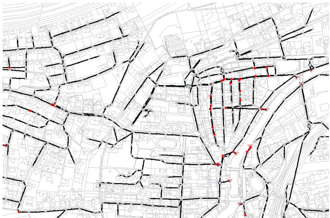
Abbildung 19b): Rot markiert sind Schächte, bei welchen Wasseraustritt übers Terrain zu erwarten ist bei Bedingungen gemäss Szenario 1
